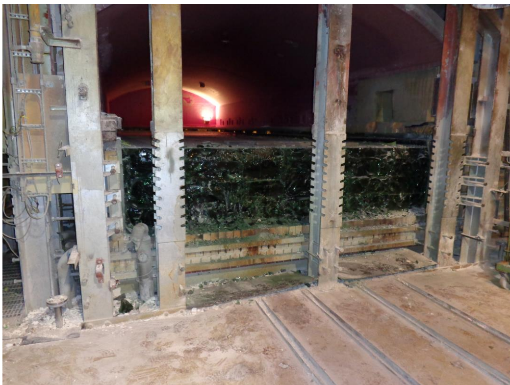
Fig. 18. Epaisse couche de verre solidifié sur la sole d'un four.
