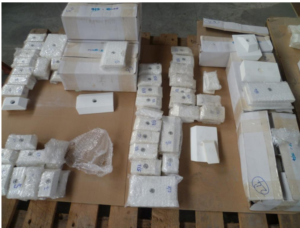
Fig. 35. Kit de pièces en céramique anti-usure numérotées pour une tuyère (brûleur de chaudière).
