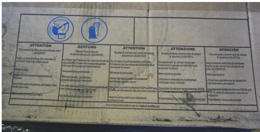
Fig. 51. Etiquetage de conditionnement de FCR. Absence des pictogrammes de dangers.
