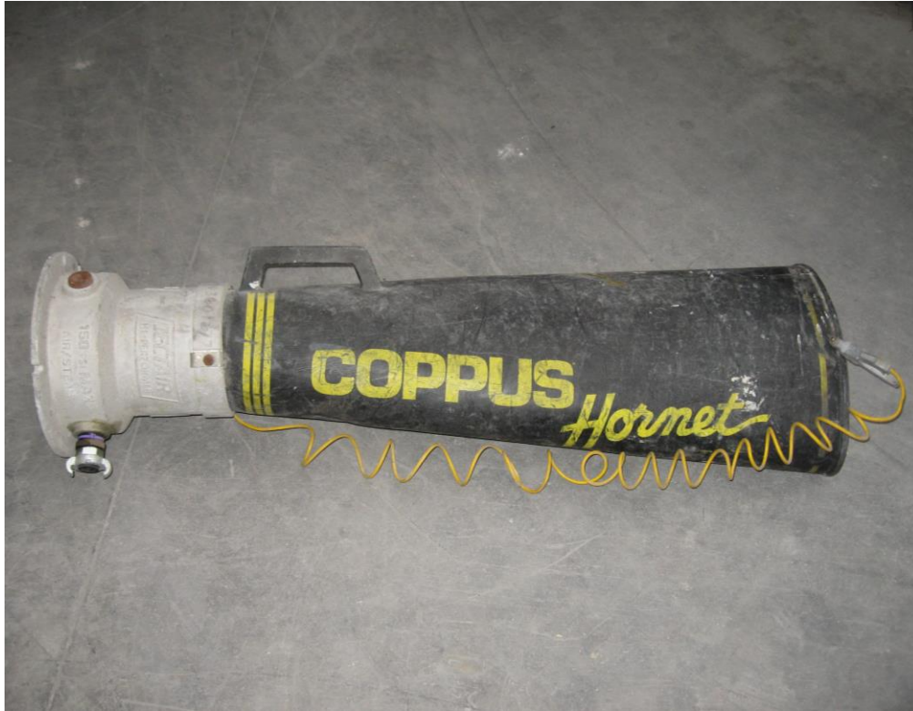
Fig. 16. Système « Venturi ». Entrée de l'air comprimé à gauche et sortie par la droite.
